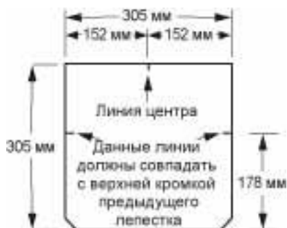
Рис. 9. Монтаж коньковой черепицы RUFLEX Ridge
