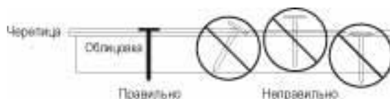
Рис. 5. Крепление гибкой черепицы гвоздями
